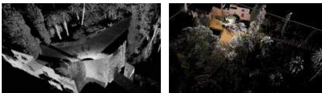
Figura 6. Nube de puntos resultante de un escaneado 3D de 360° x 270°. Derecha nube de puntos con asignación de RGB real. Elaboración propia a partir de escaneado gentileza de Riegl Measurement System GMBH
