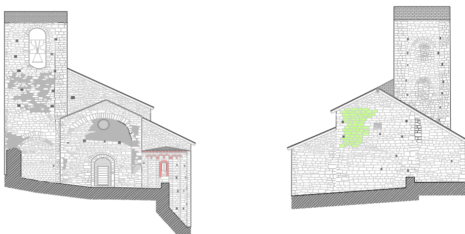
Fig. 2 Cartografía de lesiones en alzado.
