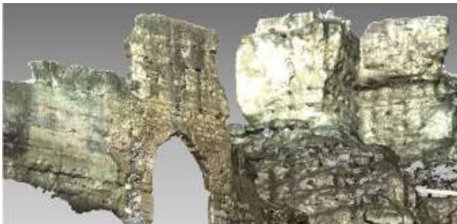
Figura 4. Modelo 3D obtenido a partir de un triple escaneado con láser "time of fly" y enlace directo de estaciones. Fuente: documentación de estudios arqueológicos de Miguel Ángel Tabales Rodríguez.
