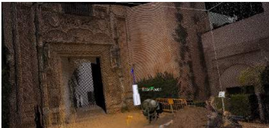
Figura 1. Nube de puntos con asignación de RGB e indicación de la posición del escáner.
