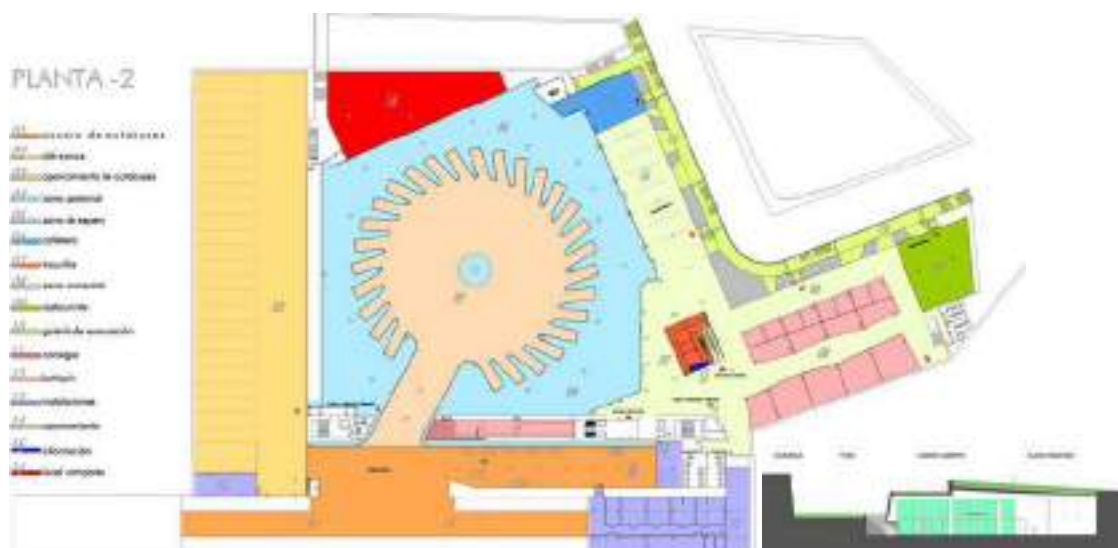
Figura 1. Planta estación de autobuses [Nivel -2] y sección transversal por área comercial.
